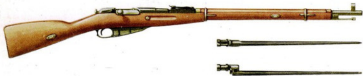
Общий вид пехотной винтовки Мосина образца 1891 года
