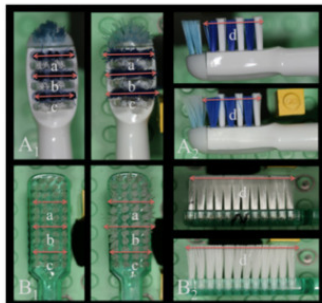
Рис. 6. Точки измерения для расчета индекса вывихнутой щетины зубной щетки Bristle Splaying Index (BSI).
