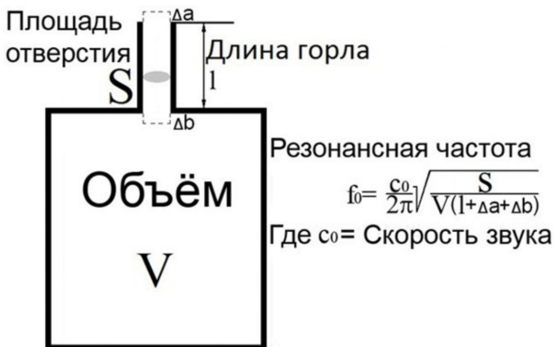
Рис. 4 К расчету резонансной частоты по способу с объемом Гельмгольца [160]
