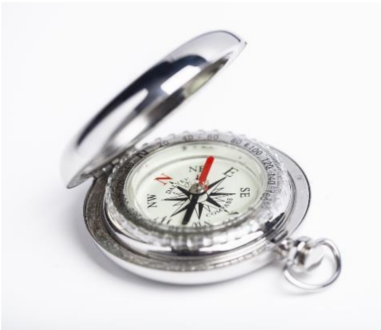
Ilustración 1.6.5 Seis de Oros. Campo magnético de la Tierra. Brújula. El campo magnético hace girar la aguja de la brújula. 69
