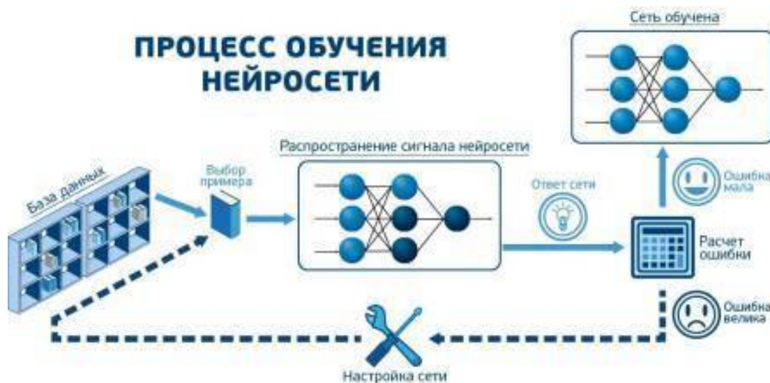
Рис. 4.2. Распространение сигнала нейросети в процессе обучения
