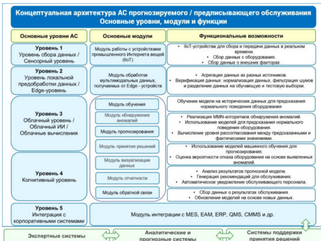
Рисунок 15. Основные уровни автоматизированной системы прогнозируемого / предписывающего обслуживания
