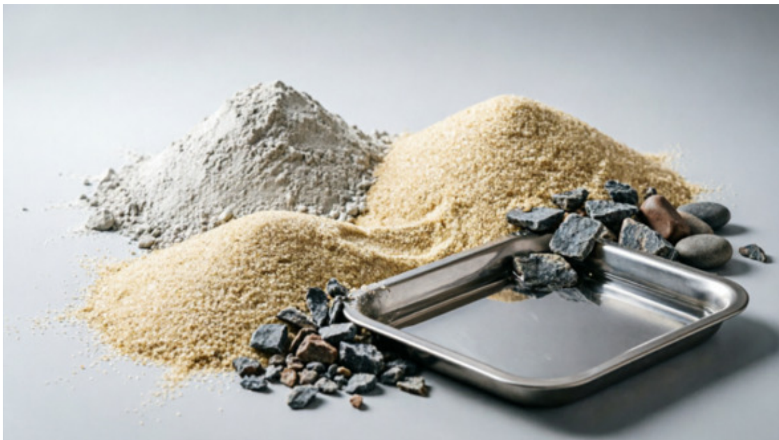
Компоненты бетонной смеси (цемент, песок, щебень, вода)
