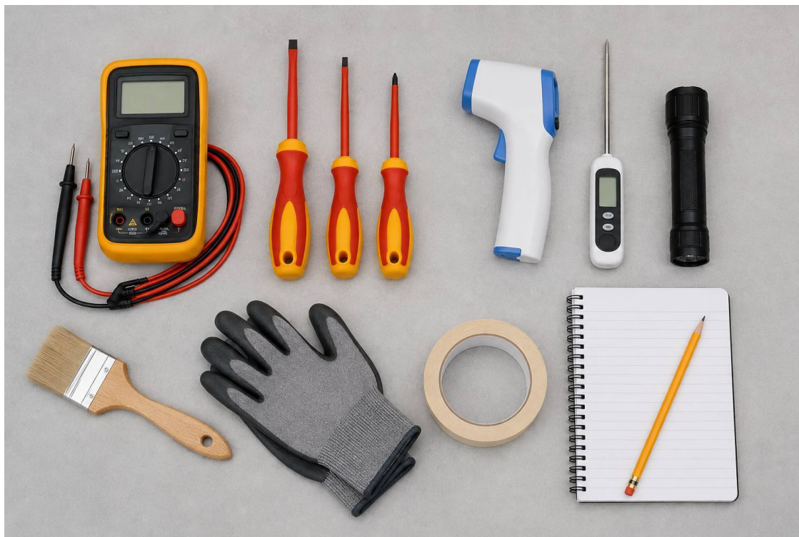
Фотография. Безопасный базовый набор: мультиметр, изолированные отвёртки, термометры, фонарь, мягкая щётка, перчатки, лента и журнал наблюдений.
