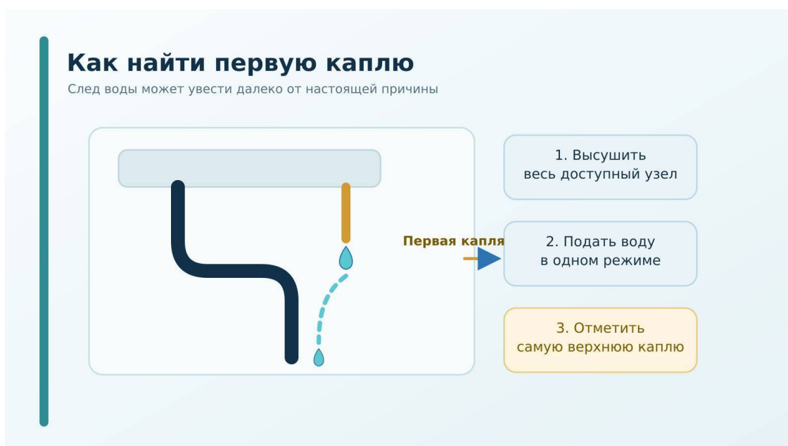
Рисунок 5. Поиск первой капли на предварительно высушенном узле
