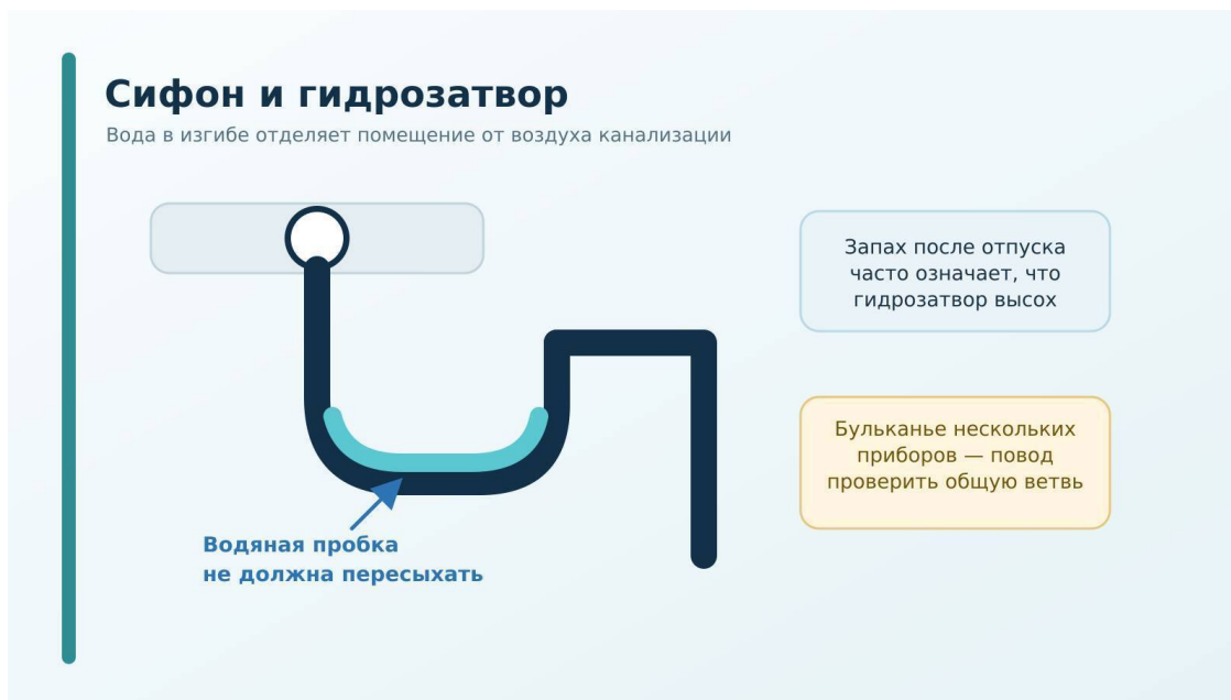
Рисунок 4. Сифон и водяной гидрозатвор
