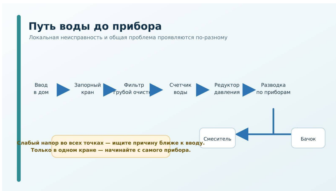
Рисунок 3. Путь воды от ввода к бытовым приборам
