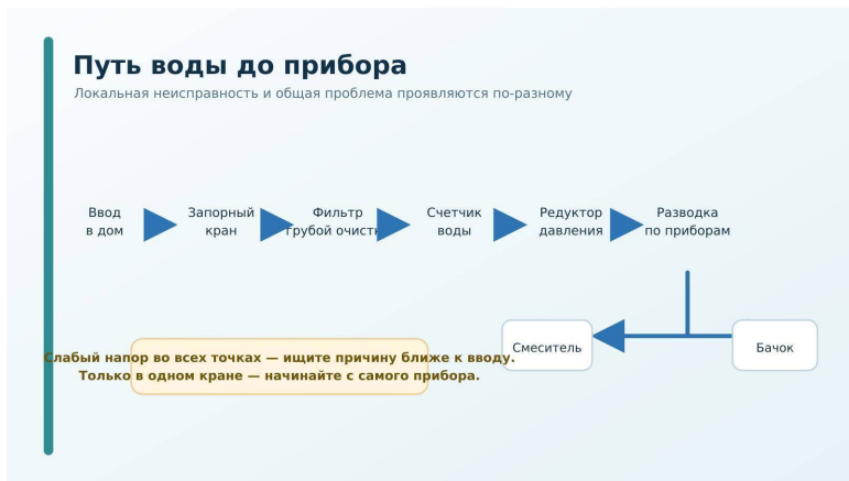
Рисунок 3. Путь воды от ввода к бытовым приборам
