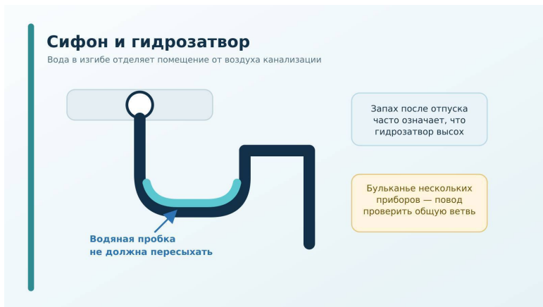
Рисунок 4. Сифон и водяной гидрозатвор
