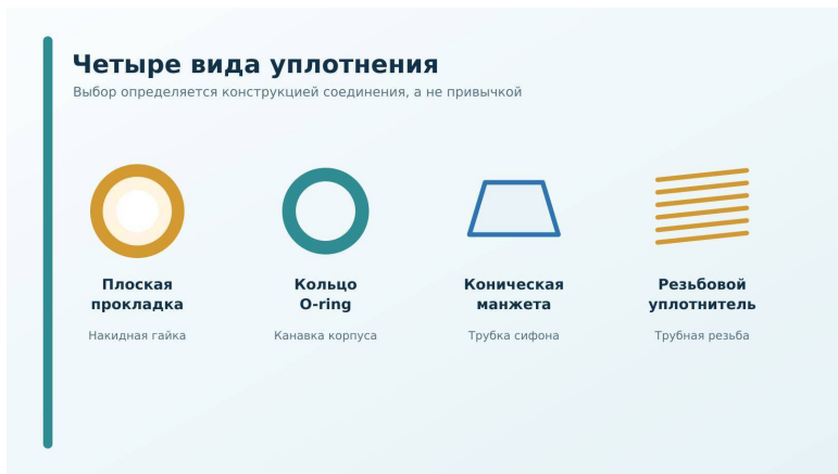
Рисунок 8. Как различаются основные виды уплотнений
