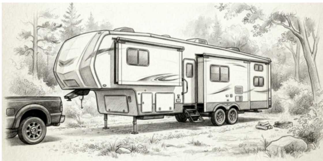
Рисунок 6. Полуприцеп Fifth-Wheel. с выдвинутым слайдером.
