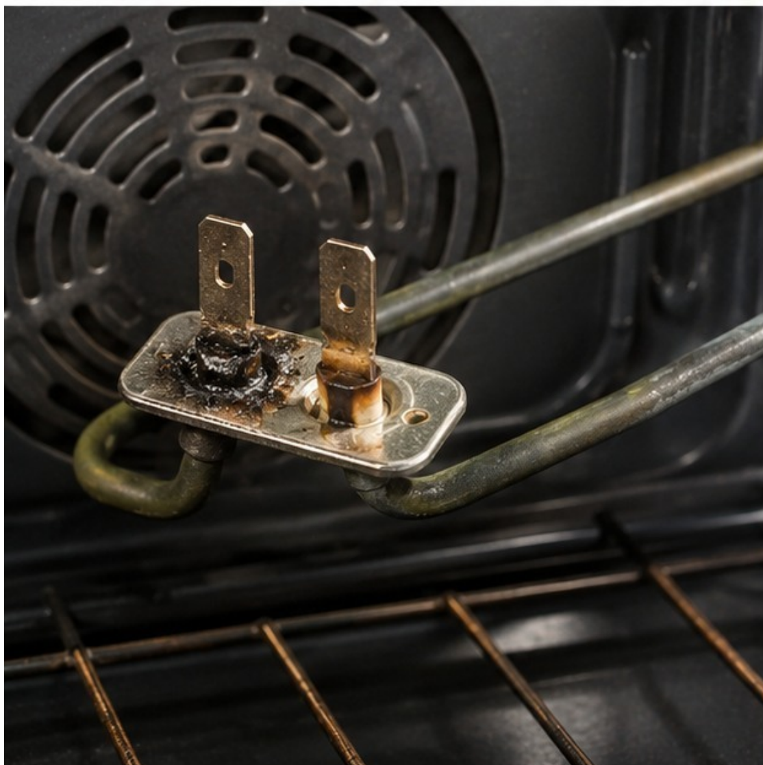
Обгоревший вывод нагревателя духового шкафа.
