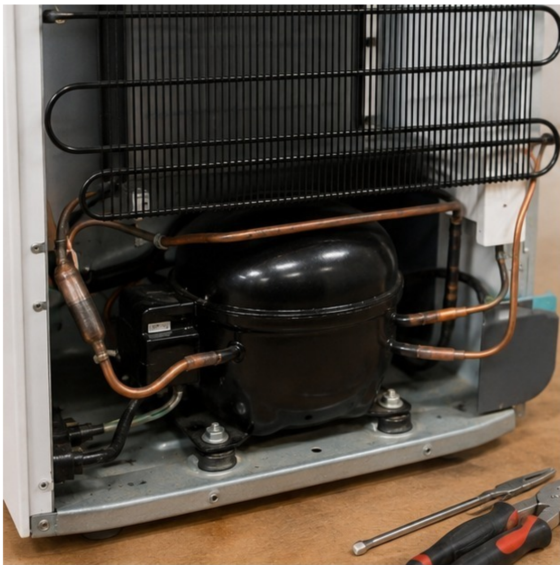
Компрессор и конденсатор холодильника.
