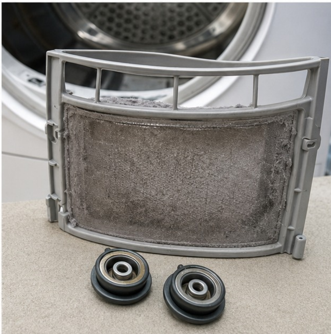
Забитый ворсовый фильтр и опорные ролики сушильной машины.
