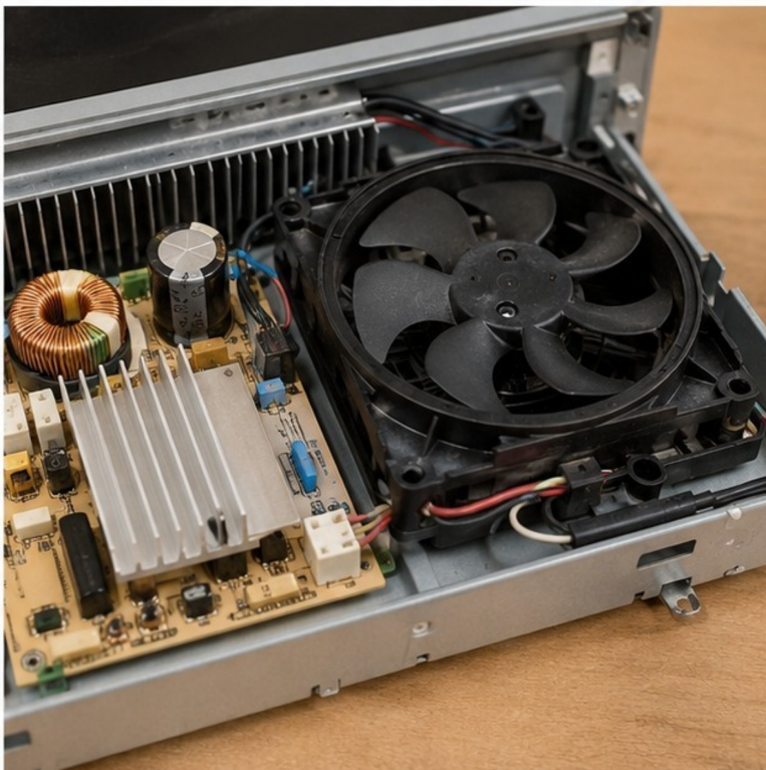
Вентилятор и силовая электроника индукционной панели.
