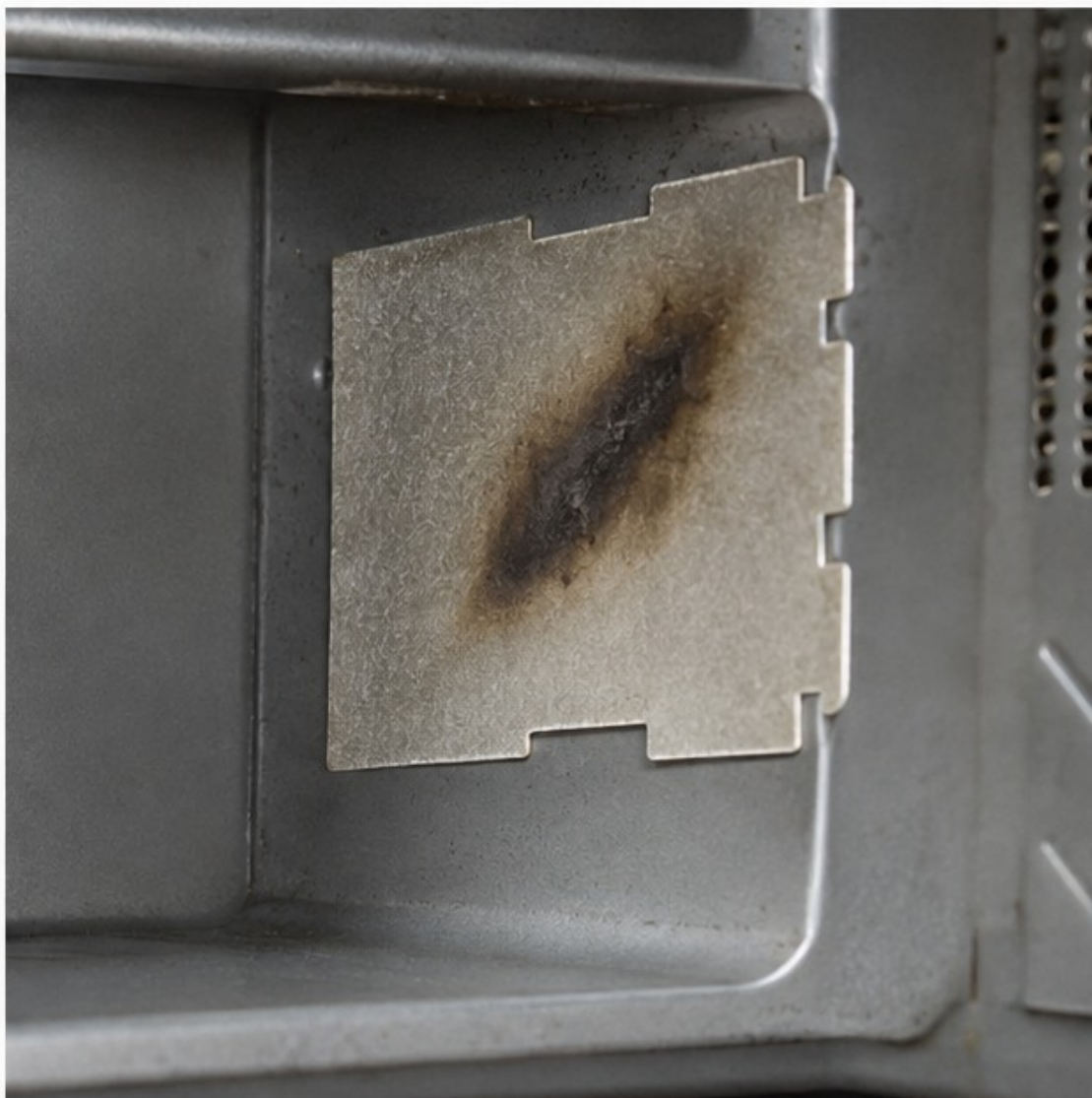
Прогоревшая слюдяная пластина микроволновой печи.
