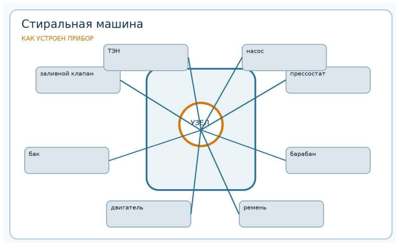
Рис. 13. Основные узлы: стиральная машина.
