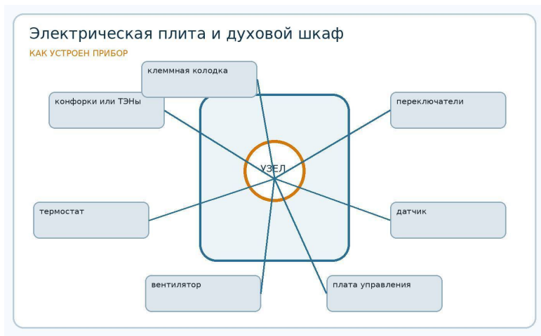
Рис. 5. Основные узлы: электрическая плита и духовой
