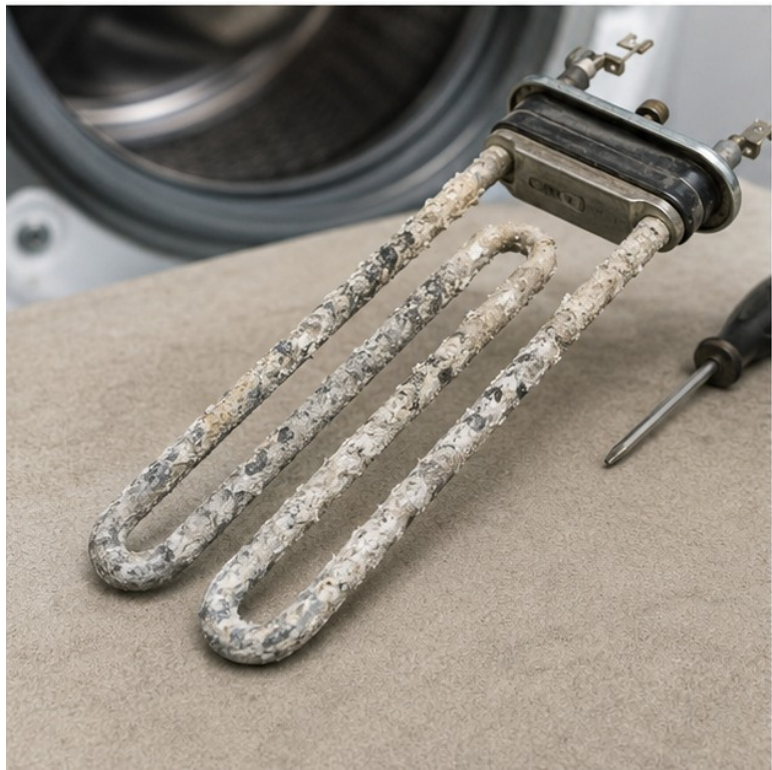
Нагреватель, покрытый накипью.
