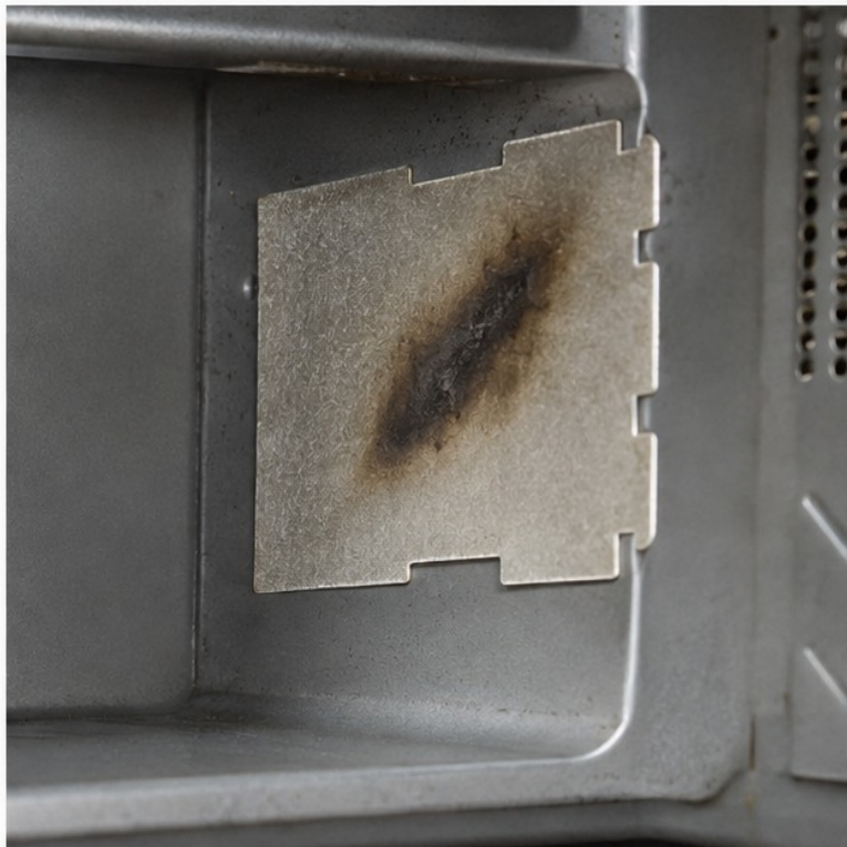
Прогоревшая слюдяная пластина микроволновой печи.
