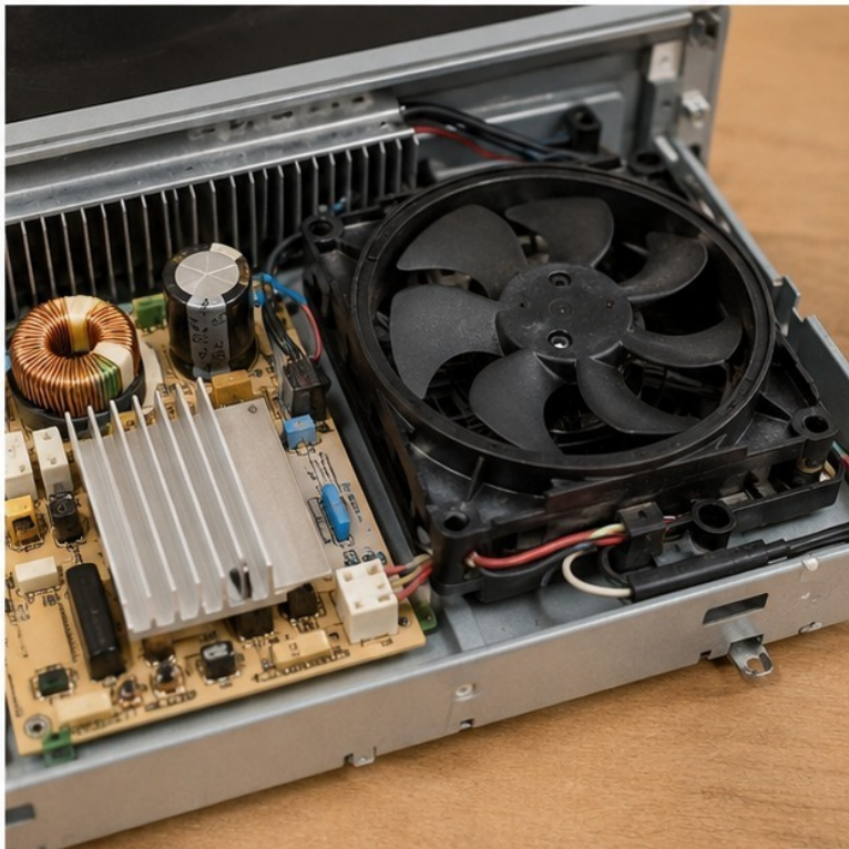
Вентилятор и силовая электроника индукционной панели.
