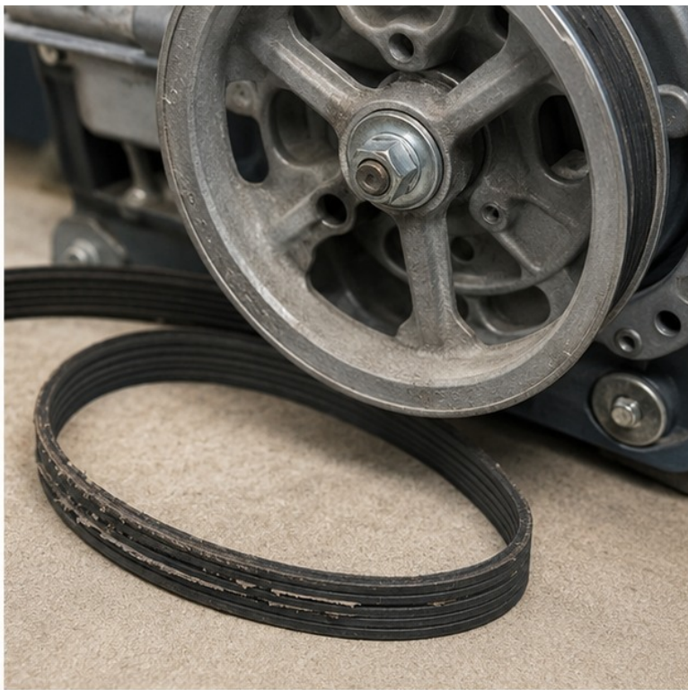
Изношенный ремень привода барабана.
