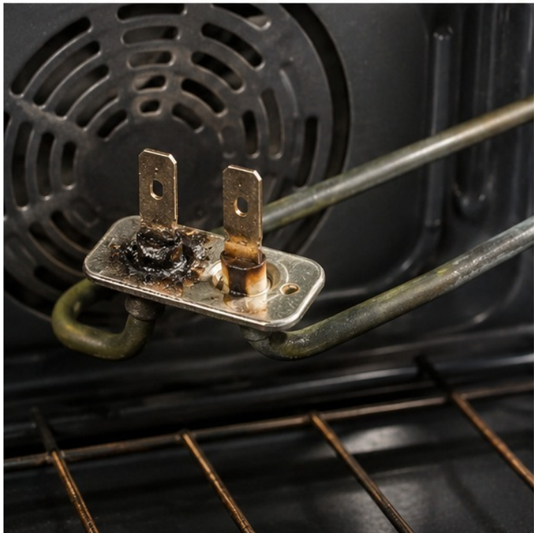
Обгоревший вывод нагревателя духового шкафа.
