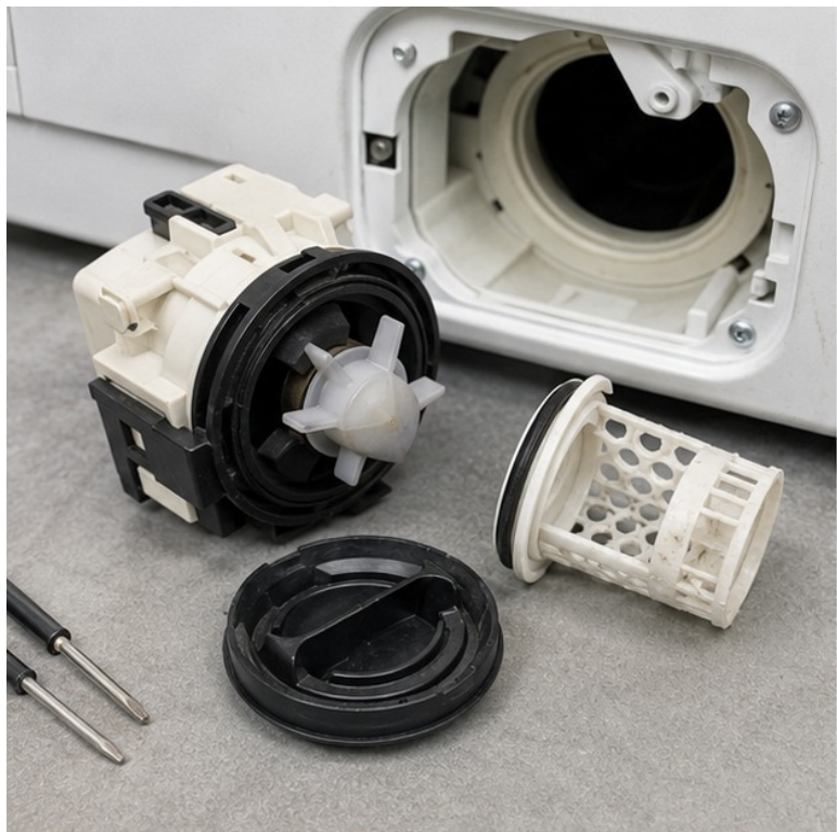
Сливной насос и фильтр стиральной машины.
