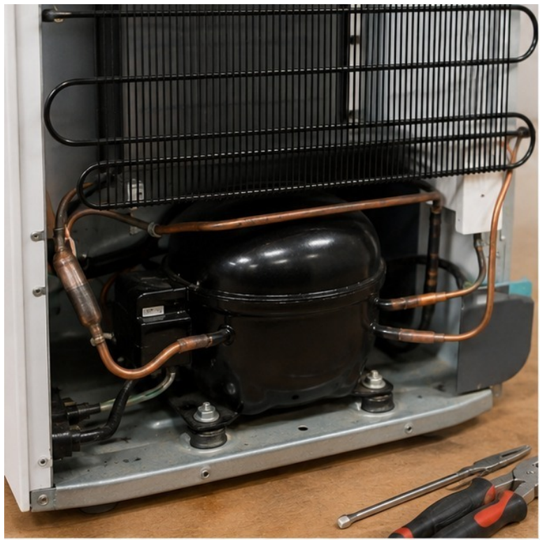
Компрессор и конденсатор холодильника.
