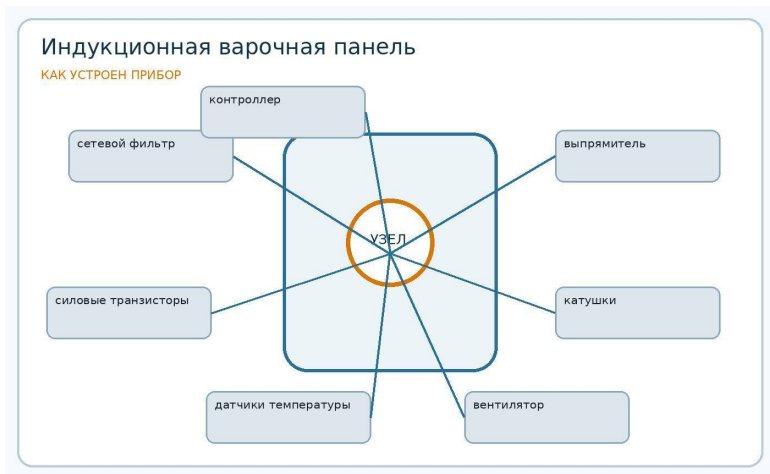
Рис. 7. Основные узлы: индукционная варочная панель.
