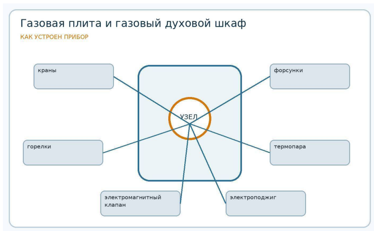
Рис. 9. Основные узлы: газовая плита и газовый духовой шкаф.
