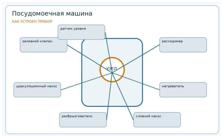
Рис. 3. Основные узлы: посудомоечная машина.
