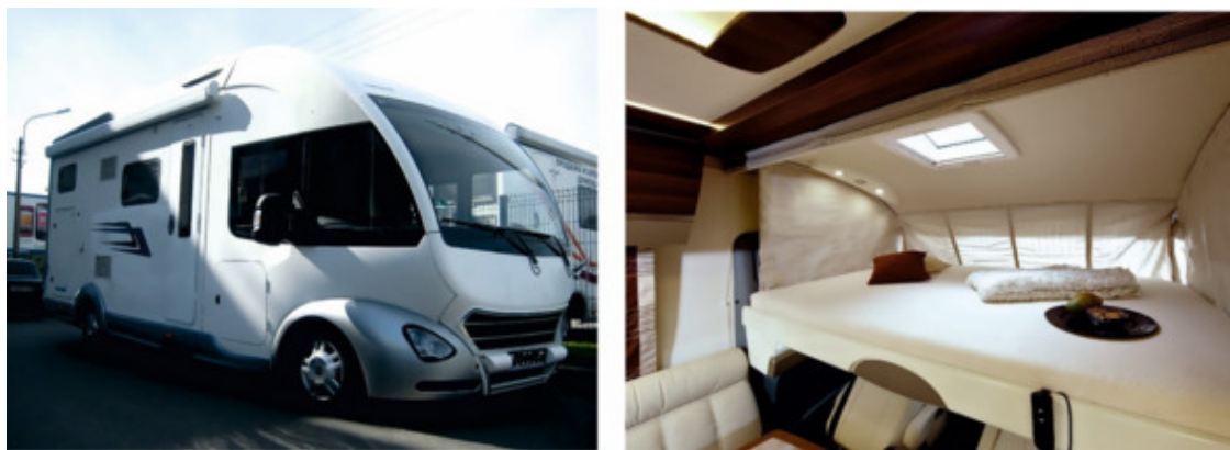
Рисунок 3 Интегрированный автодом «Eura Mobil Terrestre Integrated 660NB». Шасси Fiat-Ducato и опускающаяся кровать в передней части.
