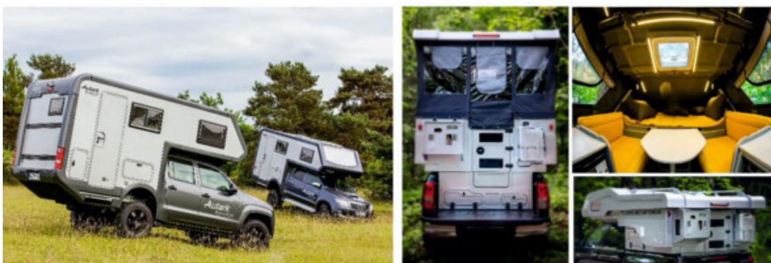
Рисунок 15. Слева: жилой модуль на пикап «WV Amarok» с жесткими стенами и крышей Немецкого производства. Справа — на ту же марку автомобиля установлен модуль с подъемной крышей, изготовленный в России.
