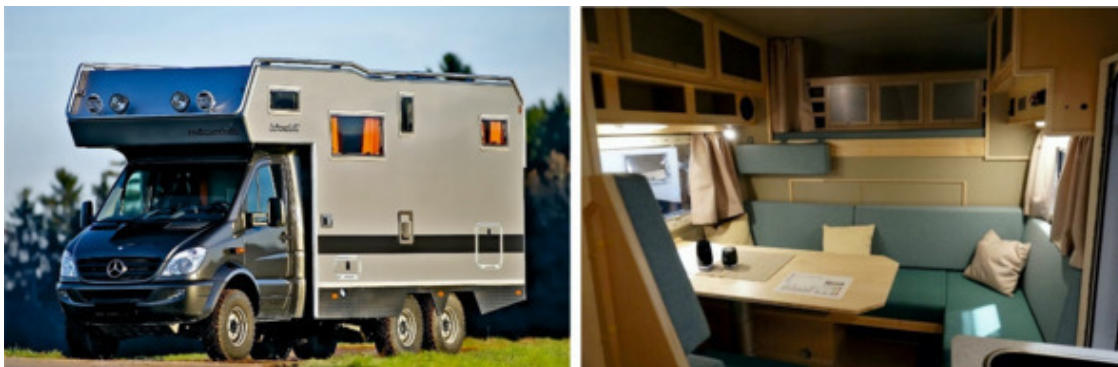
Рисунок 10. Экспедиционный автодом немецкой фирмы «Vimobil» и один из вариантов интерьера внутри. Кабина не соединяется с жилым отсеком.
