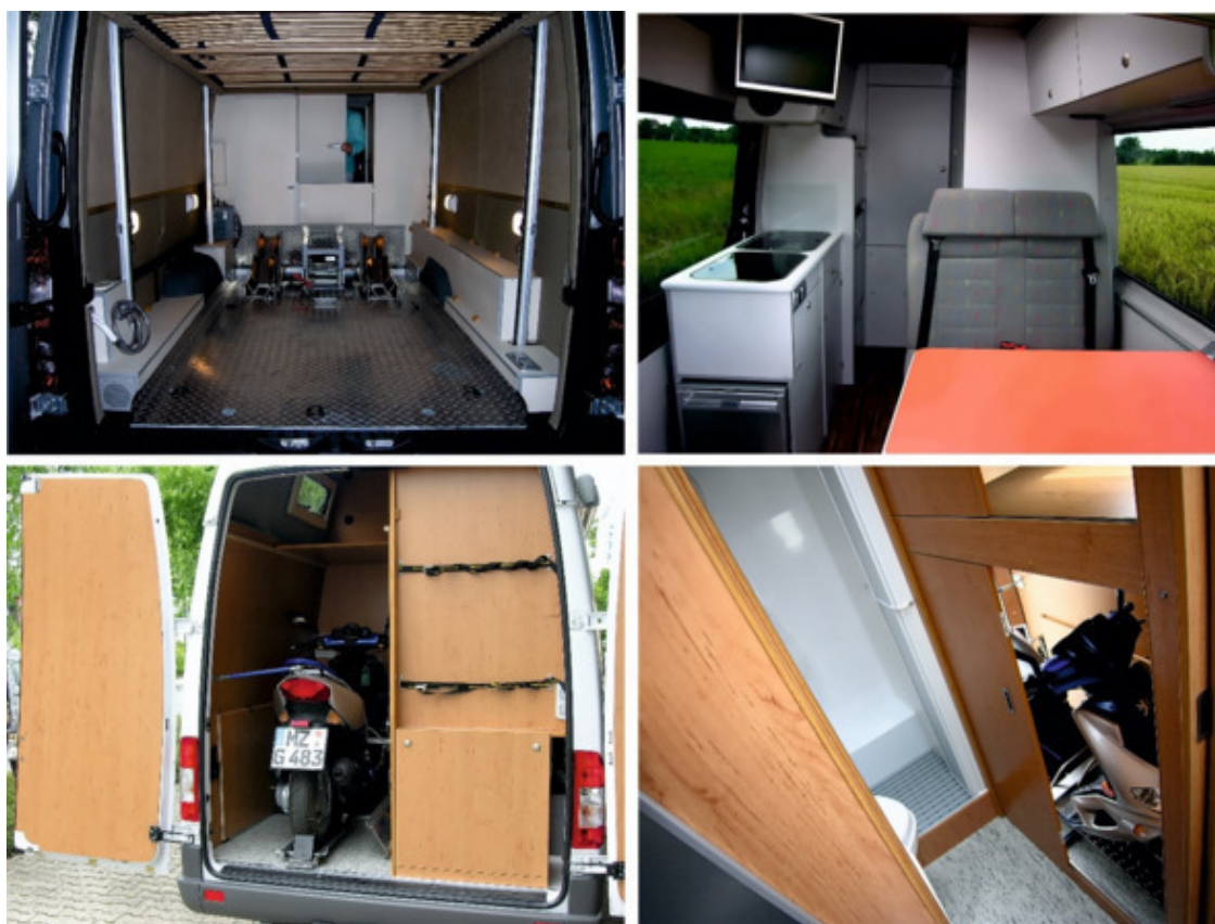
Рисунок 12. Верхнее фото: место для квадроцикла или двух мотоциклов. Спальное место опускается сверху. И вид со стороны кабины. Нижнее фото: автодом с возможностью перевозки скутера. Спальное место над гаражом.
