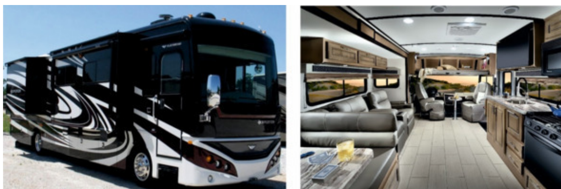
Рисунок 2. Автодом «класса А» американского производства «Fleetwood» с выдвигающимися слайдерами (стенами). Один из интерьеров такого дома на колесах.
