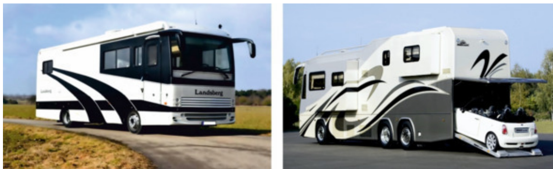
Рисунок 11. Интегрированный автодом «класса А», Европейского производства, на базе грузового автомобиля. В задней части, под спальным местом — гараж для перевозки автомобиля класса «mini».
