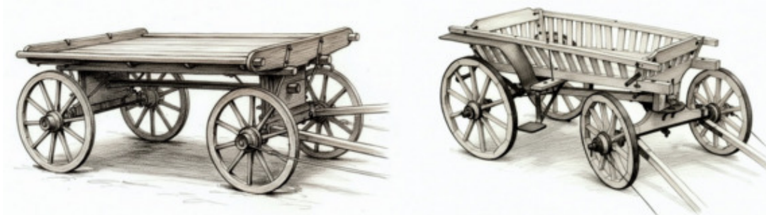
Рисунок 5. Эволюция подвески: слева — жесткая ось средневековой повозки, справа — поворотная ось
