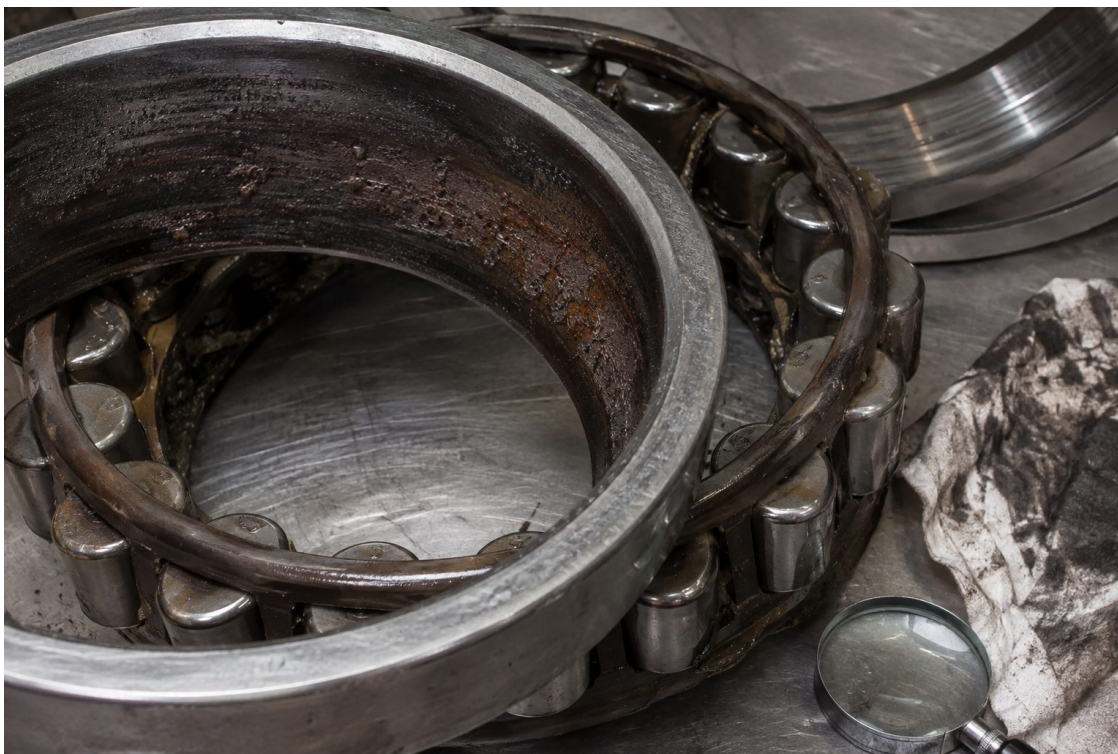
Фотореконструкция 6.1 — Загрязнённая дорожка крупного подшипника после демон- тажа
