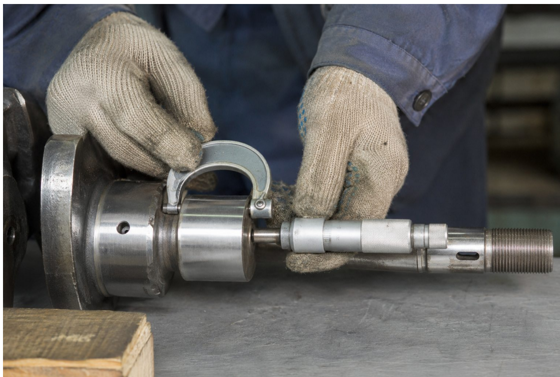
Фотореконструкция 4.1 — Измерение шейки вала наружным микрометром. Изображение создано специально для настоящего издания
