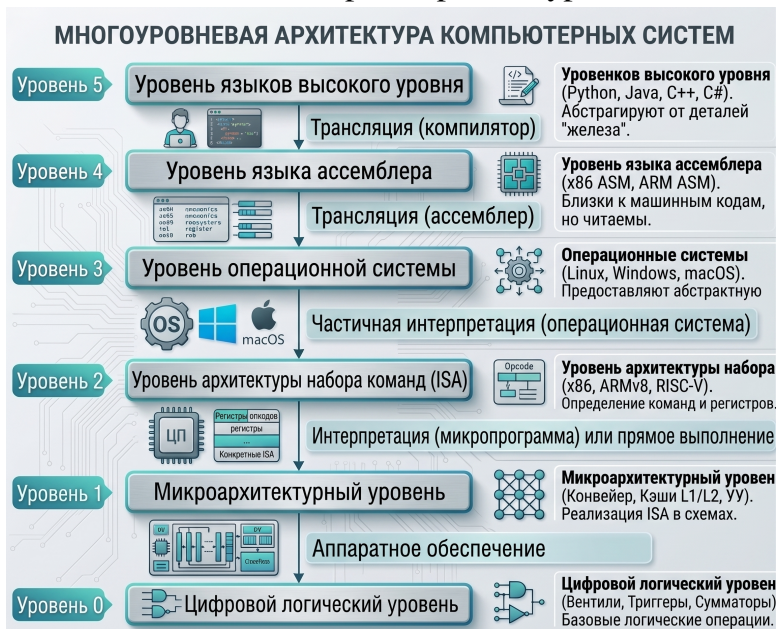
(Рис. 1–2. Шестиуровневая модель компьютера. Под
