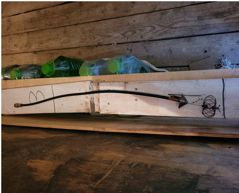
Рис. 3 Фото конструкции кабеля с противовесом и заузленной антенной
