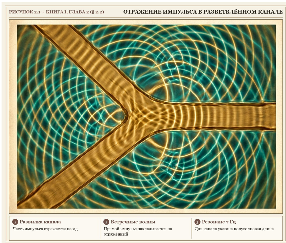
Рис. 2.1Б (Гидродинамическая визуализация и экспликация). Интерференция прямой и отражённой волн давления в Y-образном разветвлении канала (модель бифуркации аорты, \lambda/2 = L )
